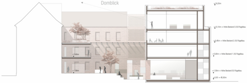
LÄNGSSCHNITT Foyer und Atrium 1:200
