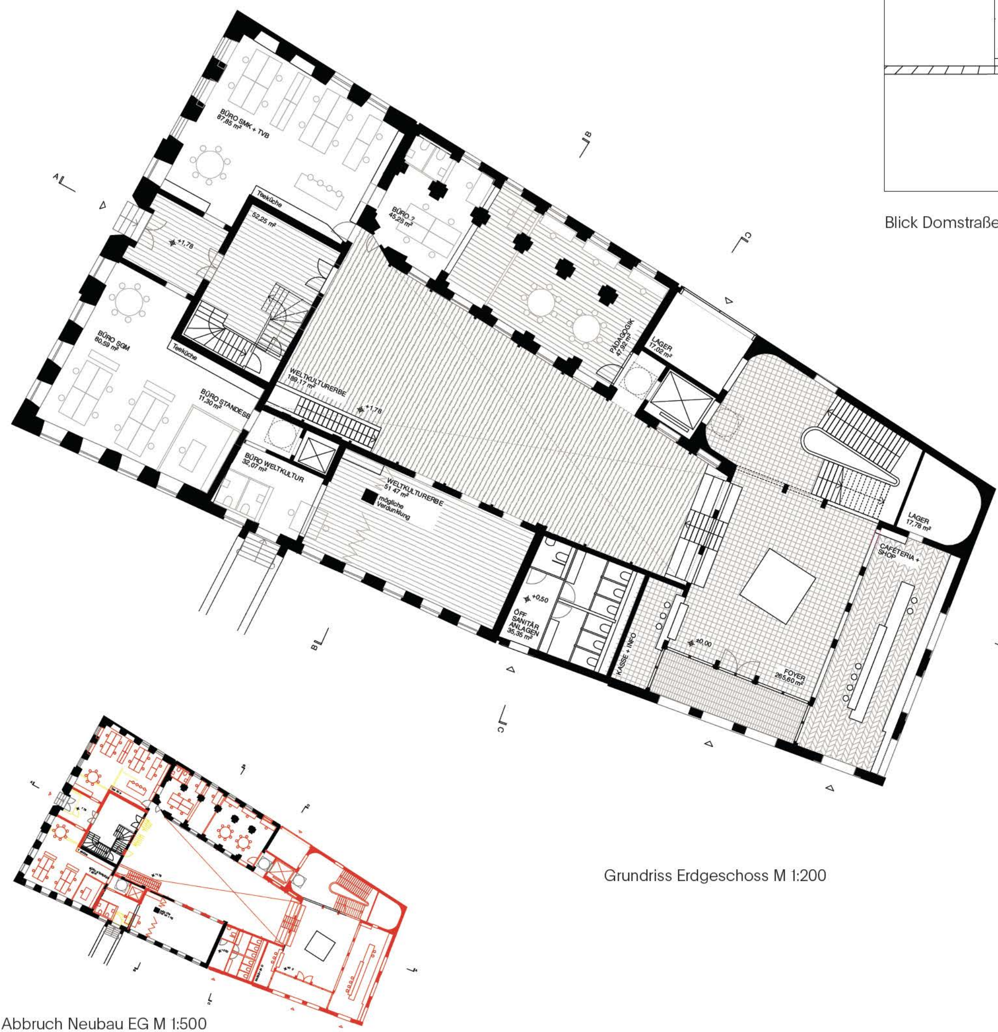
Abbruch Neubau EG M 1500
