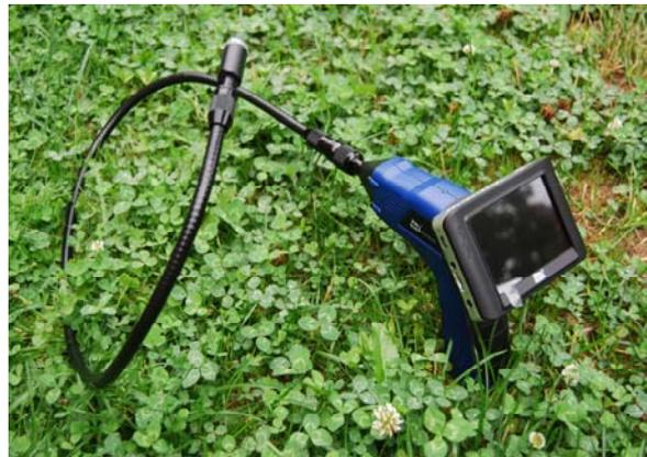
**Abb. 12:** Endoskop zur Untersuchung von Baumhöhlen und sonstigen Hohlräumen
