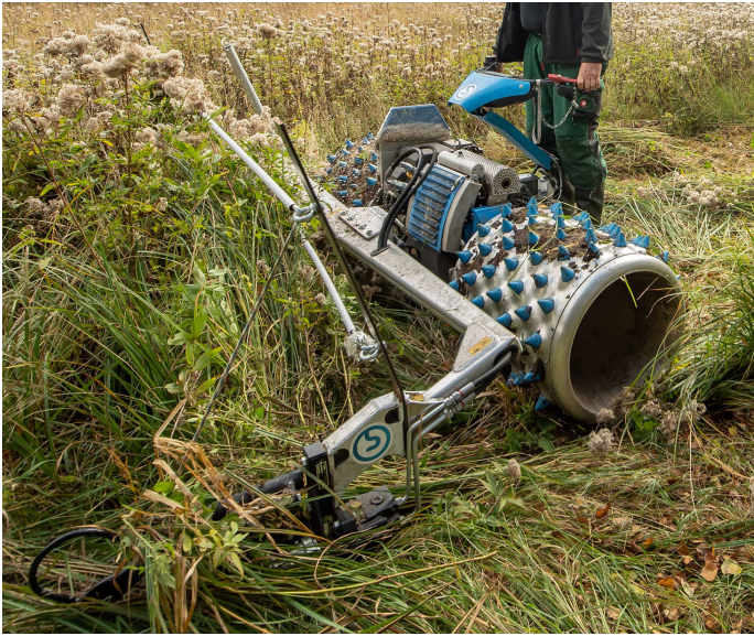
Mit dem geringen Gewicht und den breiten Stachelwalzen ist das Mähgerät besonders bodenschonend.
